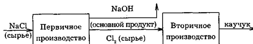
Рис. 11. Совмещенное производство щелочи и хлоропренового каучука
