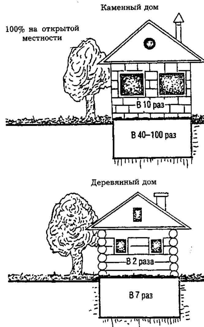
Рис. 24. Снижение уровня радиации в зависимости от типа дома
