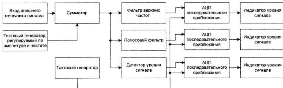
Рисунок 1. Структурная схема анализатора спектра
